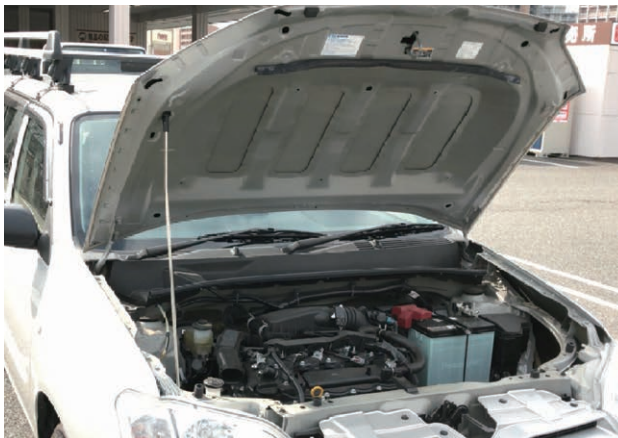
①ボンネットを開けて「ウォッシャータンク」を探します。
