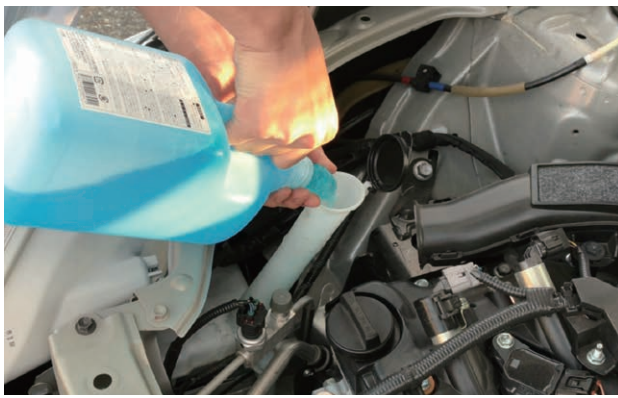
②フタを開けてゲージを見て満水量まで補充します。
